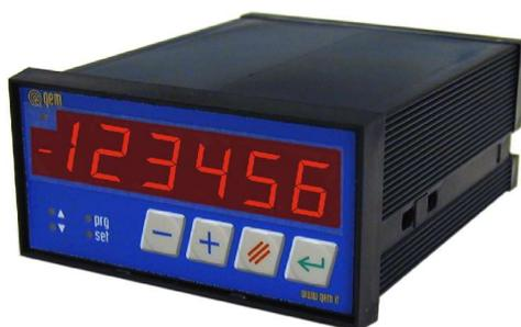
MC235.01 è un visualizzatore di quote a basso costo, che vanta caratteristiche che lo rendono multifunzionale. Dispone di moltiplicatore della risoluzione, fino a 3 cifre decimali e 2 ingressi programmabili per azzeramento, caricamento preset o somma e sottrazione di un valore sul conteggio.
